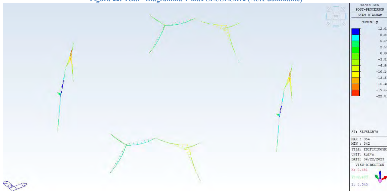
Figura 23: Controventi - Diagramma M max SLUSLCB70 (Sisma dominante)
